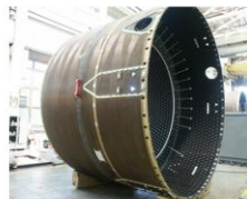
Композитный сетчатый отсек ракеты-носителя «Протон-М»
