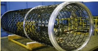
Композитная сетчатая несущая конструкция корпуса космического аппарата серии «Экспресс»
